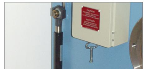
Automatische Bandspannung über einen weiten Spannungsbereich.
