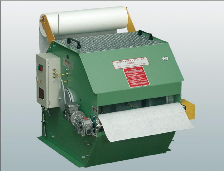
Durch die Möglichkeit, unterschiedliche Filterpapiere einzusetzen, kann der Effekt den Bedürfnissen angepasst werden.
