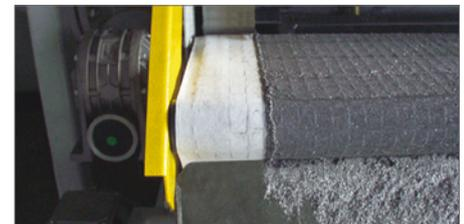
Durch eine spezielle Radgeometrie werden keine störungsanfälligen Raddichtungen benötigt.
